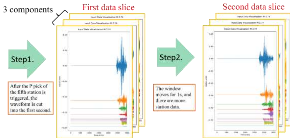
圖 5 資料處理與時間窗切片示意圖。多測站地震波形資料的處理流程及時間窗切片的方式，每個時間窗包括 30 秒的波形資料，並依時間每 1 秒逐步滑動，以捕捉不同時間段的波形特徵。
