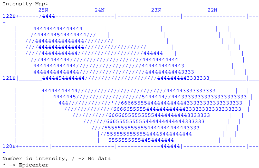
圖十二、地震速報系統自動定位結果以及震度分布圖以電子郵件方式發布的格式。(取自 Wu, et. al., 2000)
